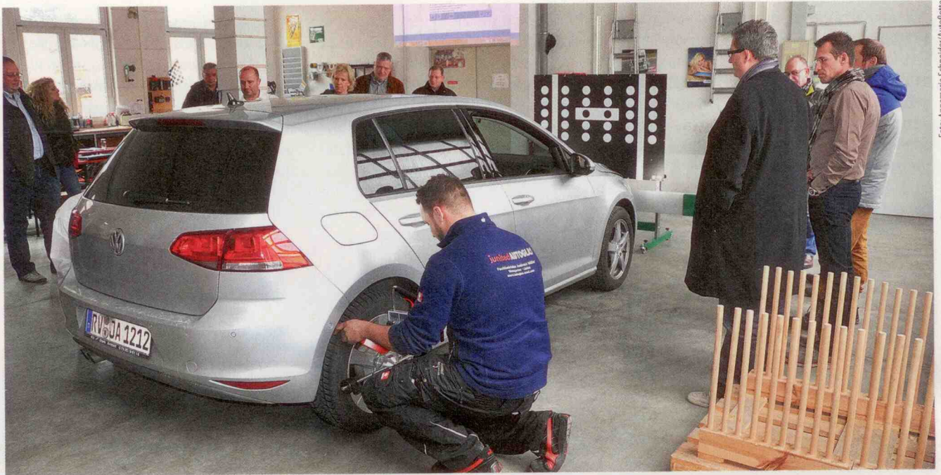
Kalibrierung beim Scheibenwechsel | Das demonstrierten die Spezialisten im Fachbetrieb Schwabo Autoglas den Teilnehmern des AFB-Treffens in Weingarten
